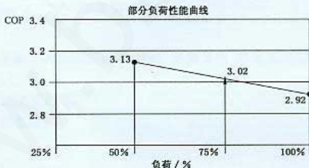
因为机组 50% 负荷点试验实测制冷量偏差在满负荷点名义制冷量的 -2% 以内,故该性能系数可作为 C 点(50%)的性能系数。
